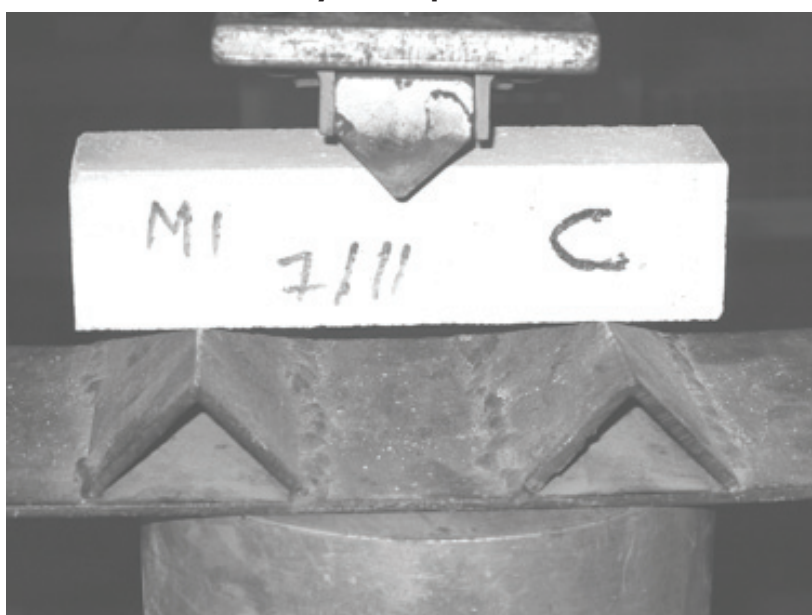
Imagen 2. Probeta con dispositivo para ensayo de flexión
