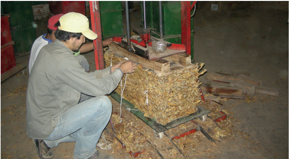
Trabajadores atando fardo (enfardado con prensa hidráulica)
