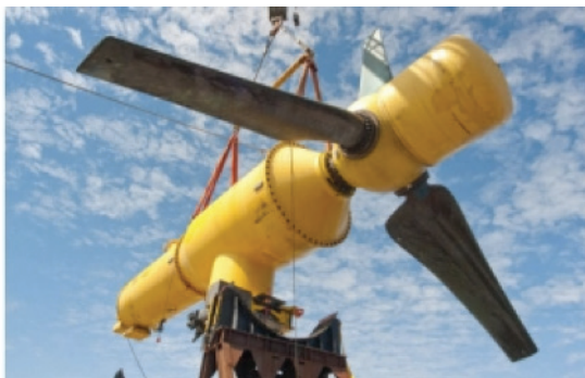
Fig. 2. Turbina para corrientes marinas (energías-renovables.com)
